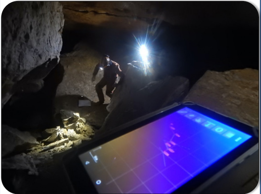
Topografía con apoyo de Tablet para toma de datos.
